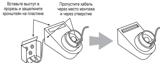
6. Наденьте крышку выходов на кронштейн, как показано на рисунке ниже, после чего подключите провода, идущие к динамику, к выходам на нижней части динамика. При подключении соблюдайте полярность.
