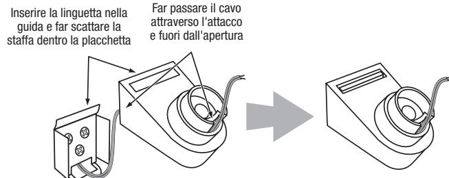
6. Inserire la copertura per terminali nella staffa come indicato nella figura in basso, quindi collegare le punte finali del cavo per diffusori ai terminali nella parte inferiore del diffusore. Ricordarsi di rispettare la corretta polarità.
