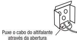
4. Conduza o cabo do altifalante através da abertura em forma de arco na parte superior do suporte de montagem, não através da abertura do parafuso.
