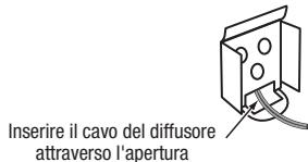
4. Infilare il cavo del diffusore nell'apertura a forma di arco in cima alla staffa di montaggio, non nel foro per le viti.
