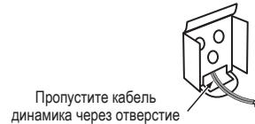
4. Пропустите кабель динамика через отверстие-сектор в верхней части кронштейна. Не перепутайте его с отверстием для винта.
