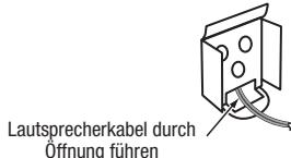
4. Führen Sie das Lautsprechkabel durch die bogenförmige Öffnung oben auf der Wandhalterung, nicht durch das Schraubenloch.
